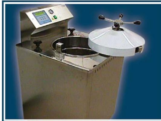
**AUTOCLAVE: EQUIPAMENTO UTILIZADO GERALMENTE EM INSTITUIÇÕES DE SAÚDE PARA PROMOVER A DESINFECÇÃO POR CALOR ÚMIDO DE MATERIAIS CONTAMINADOS, FUNCIONA COMO UMA GRANDE "PANELA DE PRESSÃO"**
