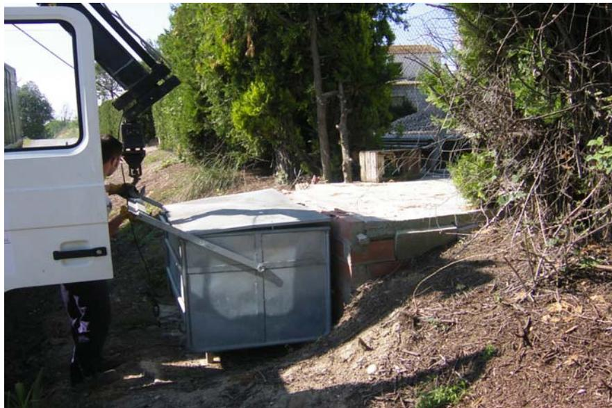
Contenedor situado en el perímetro de una explotación ganadera, al cual se accede mediante un pasillo elevado. Foto cortesía del DARP – Generalitat de Catalunya.
